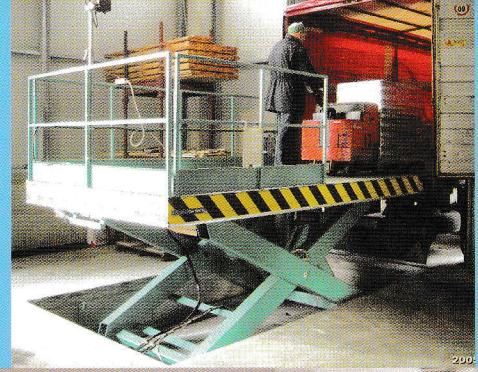
La flessibilità produttiva di Arco Industrie consente di realizzare tipologie speciali di rampe secondo le esigenze del cliente: in INOX con portate superiori, per situazioni di carico particolari, ecc.
